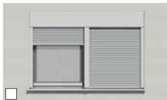
Kopplung Rollladenelemente mit Doppelführungsschiene
