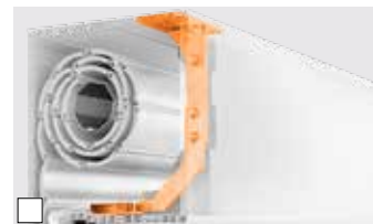
Blendrahmenstabilisierung für zusätzliche Stabilität bei breiten Fenstern
